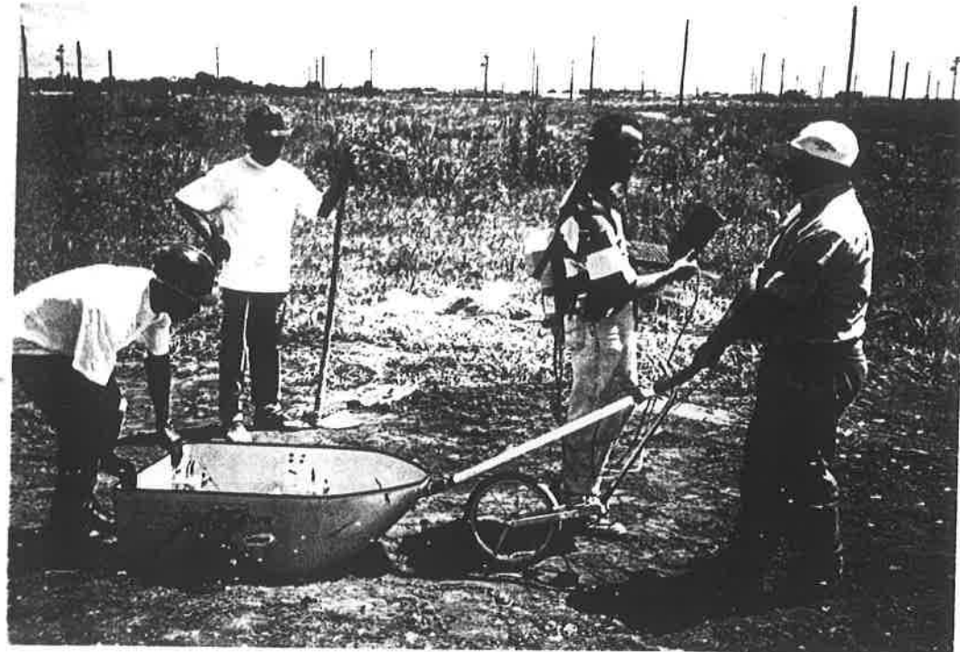
Foto 5 - O barquinho de fibra serve de suporte para a antena do GPR, deslizando sobre a superfície que será radiografada, informando ao arqueólogo da possível existência de objetos e estruturas enterradas, agilizando as escavações.
